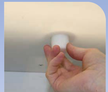
Kalibrierung des Sauerstoffsensors direkt in der Kammer
